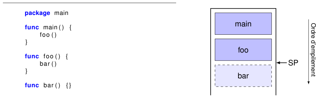
FIGURE 2 – Un programme avec plusieurs fonctions et un aperçu de l'état de la pile juste après le retour de la fonction bar
